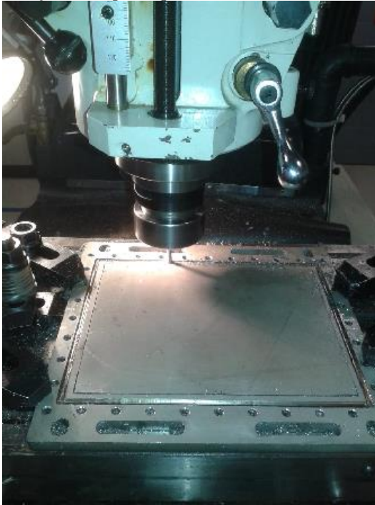
Figura 37– Fabricação dos suportes para os bocais.
