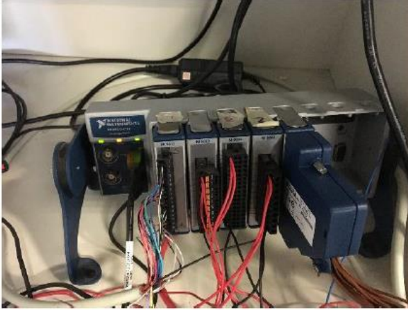
Figura 56– Sistema de aquisição de dados, NI cDAQ-9178.
