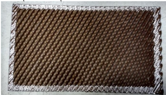
Figura 33– Chapas de titânio após serem conformadas mecanicamente.
