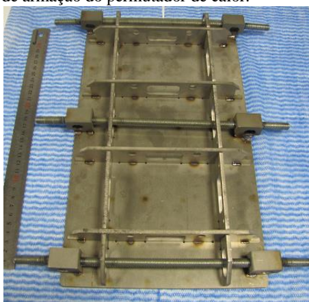
Figura 39– Placa de armação do permutador de calor.
