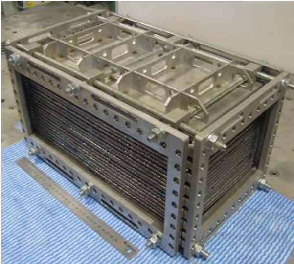
Figura 41– Núcleo do trocador de calor com as placas de armação e de encaixe de bocais.
