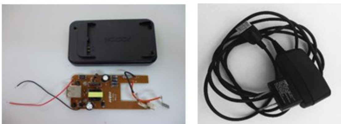
Figura 49 - Elementos componentes do módulo carregador
