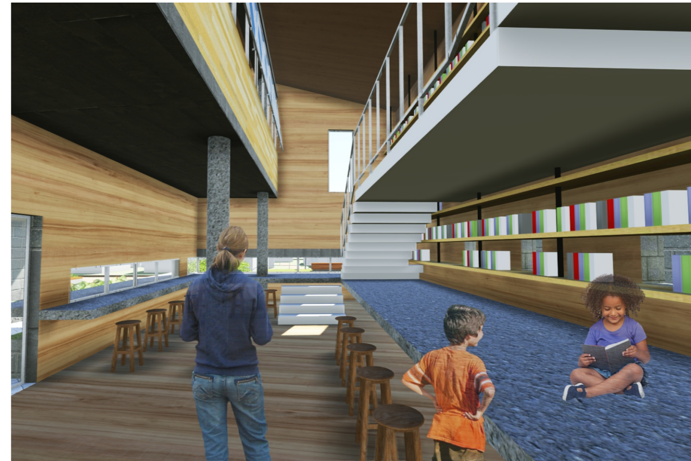
A PERSPECTIVA DA RUA INTERNA ABRE-SE AO CHEGAR NA BIBLIOTECA. NELA, O USUÁRIO ENCONTRA UM AMBIENTE DE PÉ DIREITO DUPLO QUE POSSIBILITA UMA APROPRIAÇÃO LIVRE, ENTRE PATAMARES, BALCÕES E ESTANTES DE LIVROS. O SOLÁRIO POSSUI FACHADA EM VIDRO VOLTADA PARA O NORTE E PLACAS DE DRY WALL FORAM POSICIONADAS NA PARTE INFERIOR DAS ABERTURAS, INTENSIFICANDO O GANHO DE CALOR DO AMBIENTE DURANTE O INVERNO. NO VERÃO, TODO O ESPAÇO PODE SER VENTILADO ATRAVÉS DE UM SISTEMA DE ABERTURAS (CORTE BB').
