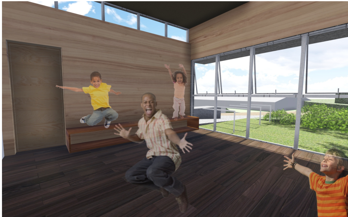
SALA MULTIUSO: A FACHADA NORTE, DURANTE O INVERNO, APROVEITA A TRAJETÓRIA MAIS INCLINADA DO SOL PARA INTENSIFICAR O GANHO DE CALOR DA EDIFICAÇÃO ATRAVÉS DO VIDRO. NO VERÃO, O BRISE HORIZONTAL AJUDA A DIMINUIR A INCIDÊNCIA SOLAR.
