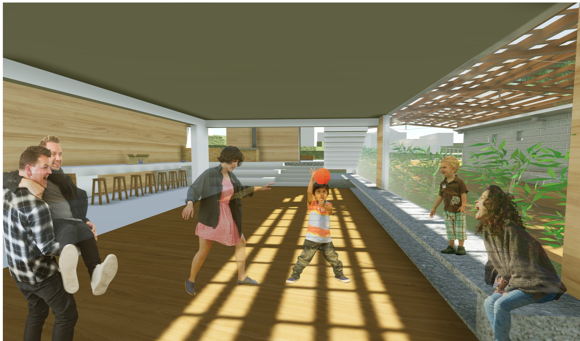
OFICINA/ATELIÊ: O ESPAÇO É ESTRUTURADO ATRAVÉS DE UM SISTEMA DE PILARES E VIGAS EM CONCRETO ARMADO, COM VEDAÇÃO EM BLOCO DE CONCRETO E REVESTIMENTO EM PLACAS DE MADEIRA. AS GRANDES ABERTURAS DE CORRER SÃO METÁLICAS. NO NÍVEL DA RUA, O PLANO DO PISO É PROLONGADO, FORMANDO UMA MESA COLETIVA PARA ATIVIDADES DE ATELIÊ.
