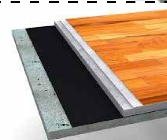
REVESTIMENTO DE PISO: APLICADO ACIMA DO PISO EXISTENTE OU DO CONTRAPISO, SÃO TRÊS CAMADAS: MANTA ACÚSTICA, ISOPOR E LAMINADO DE MADEIRA
