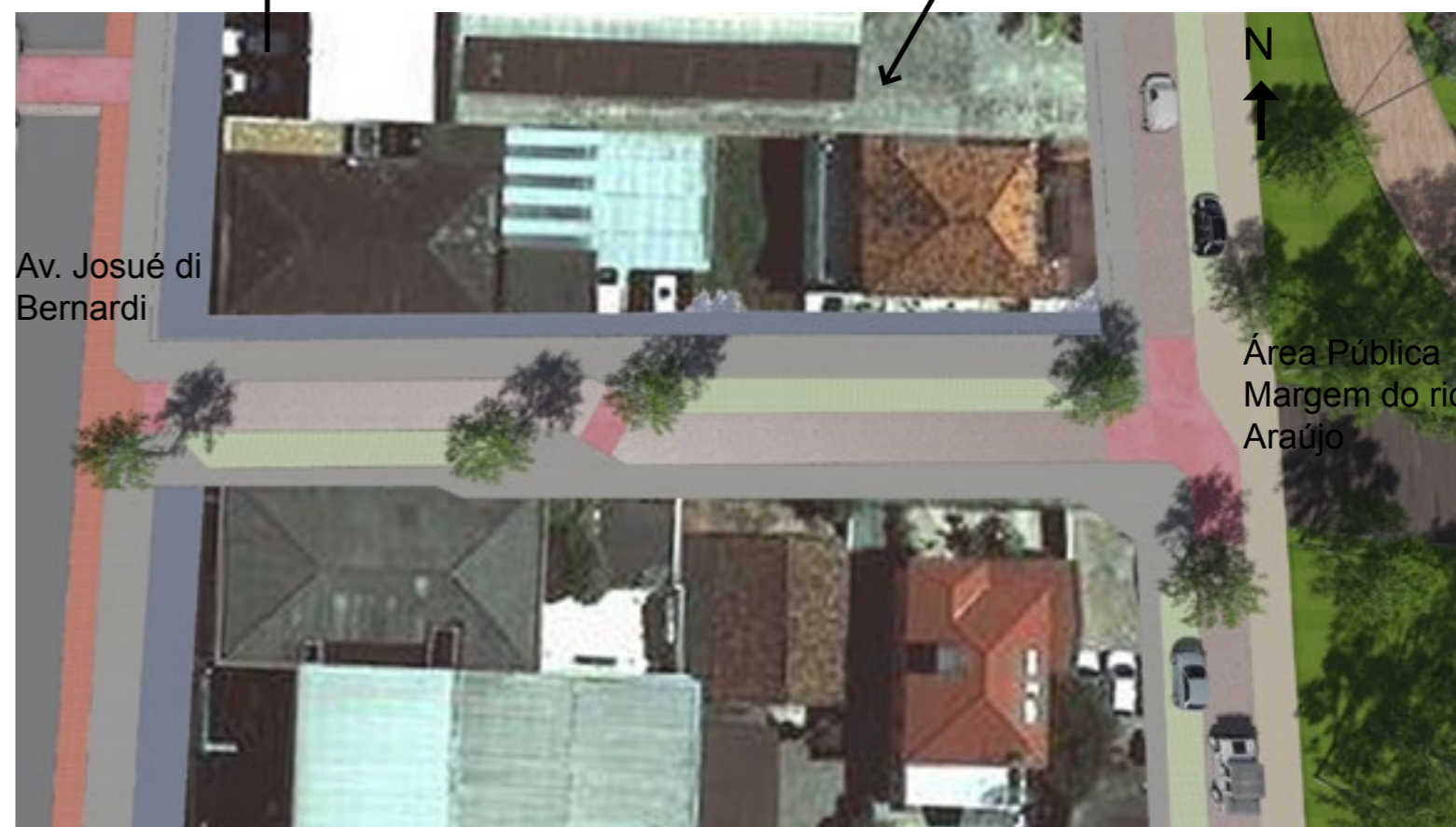
Vista superior da via entre a Av. Josué di Bernardi e rio Araújo, transformada em mão única, alargamento das calçadas e uso de pisos drenantes nas calçadas, estacionamentos e via. Sem escala.
