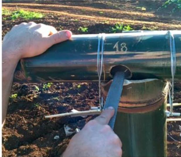
**Figura 20: Ajuste final do furo número 18 usando grosa.**
