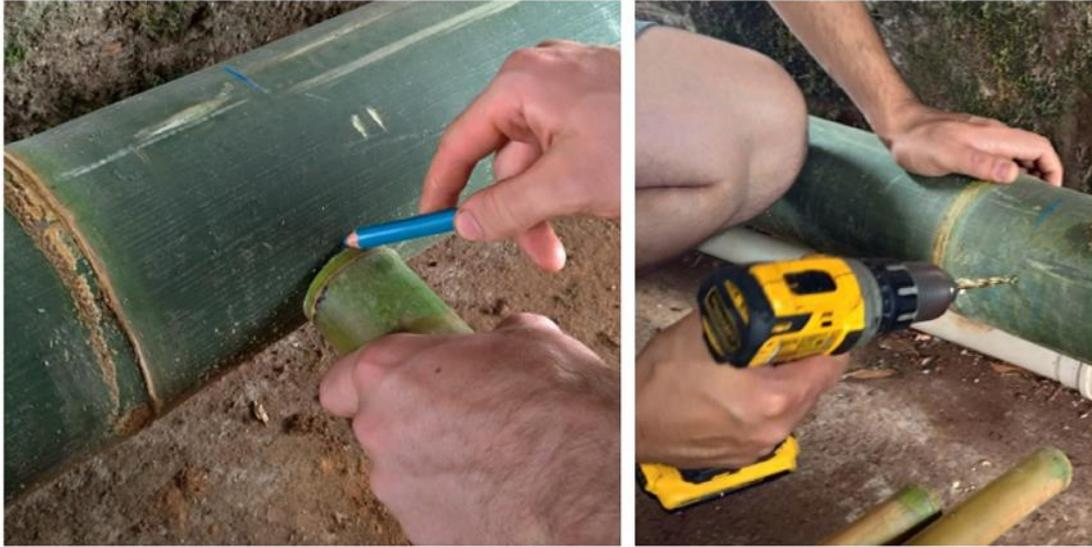
**Figura 10: Fazendo marcação e furos para encaixe de colmo de cana da Índia no bambu gigante.**
