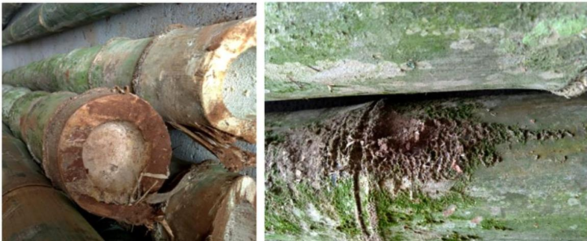
Figura 4: Colmos sujos de bambu gigante e detalhe dos líquens sobre os colmos.
