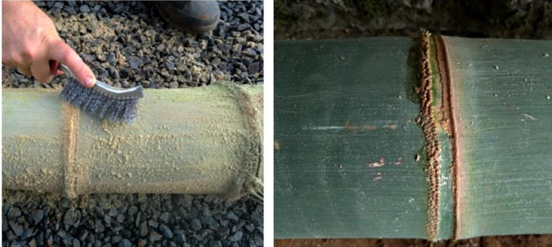
**Figura 6: Limpeza dos colmos de bambu gigante usando escova de aço.**
