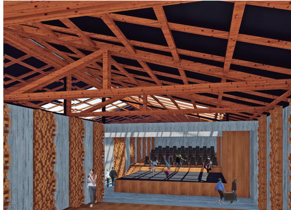
Vista interna do teatro. Destaque para a entrada de luz pela cobertura. Mantém-se a volumetria do respiro do telhado que existe originalmente, porém é proposto seu envidraçamento para que funcione como uma clarabóia de iluminação durante o dia.
