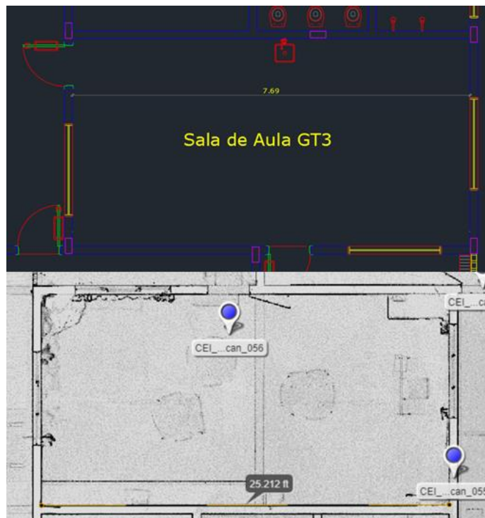
Figura 36 – Medidas da sala de aula GT3 no “.dwg” e no FARO Box
