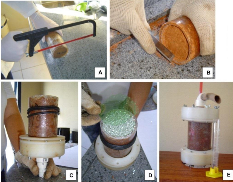
Figura 4.14 – Sequência de montagem das células de permeâmetros com amostras indeformadas oriundas de coleta a frio
