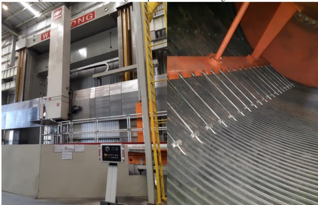
Figura 21 - Torno vertical de grande porte e detalhe da usinagem interna da camisa
