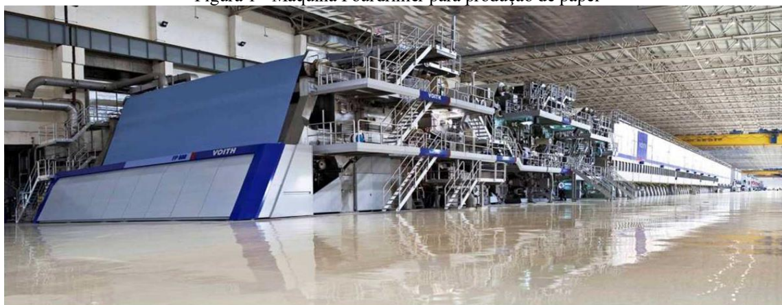
Figura 1 - Máquina Fourdrinier para produção de papel
