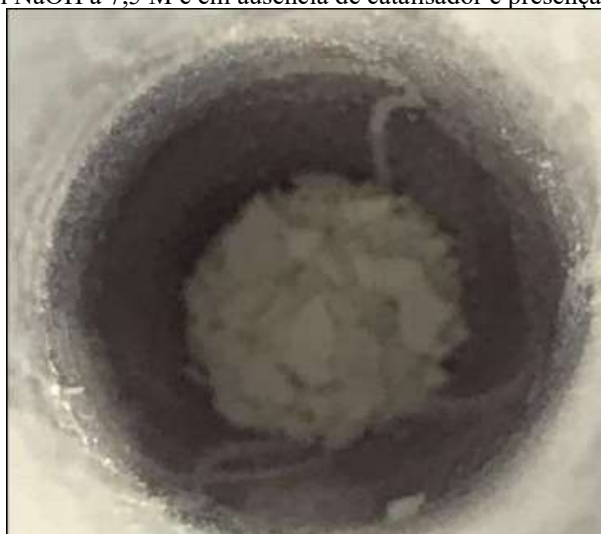
Figura 22 - TPA obtido com NaOH a 7,5 M e em ausência de catalisador e presença de agitação.
