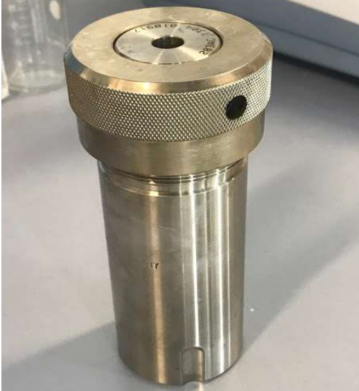
Figura 18 - Autoclave utilizada nos ensaios com ausência de agitação.
