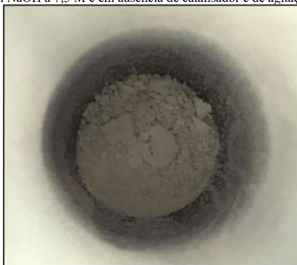
Figura 21 - TPA obtido com NaOH a 7,5 M e em ausência de catalisador e de agitação.
