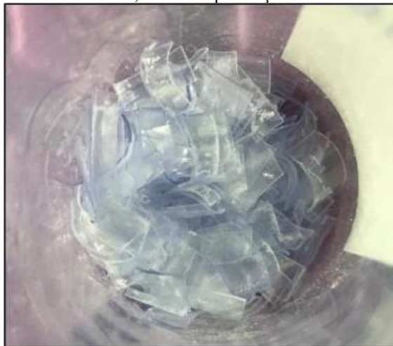
Figura 24 – PET não degradado com NaOH a 2,5 M e em presença de catalisador e de agitação.
