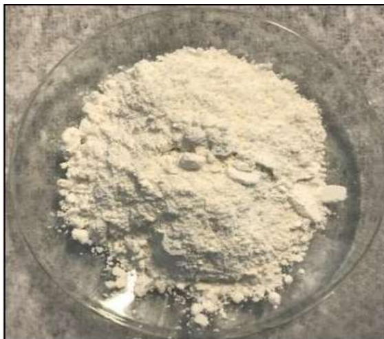
Figura 25 - TPA obtido no processo com \text{NH}_4\text{OH} em substituição ao \text{NaOH} .
