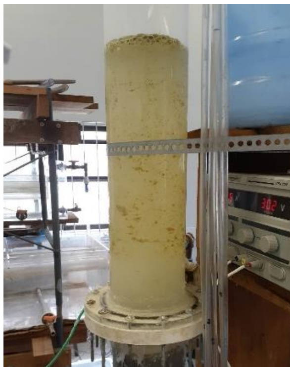
Figura 5 - Material flotado depositado na superfície da coluna líquida.
