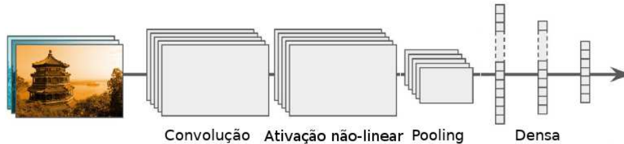
Figura 6 – Arquitetura típica de uma rede neural convolucional. Fonte: Géron (2017), adaptado pelo autor.
