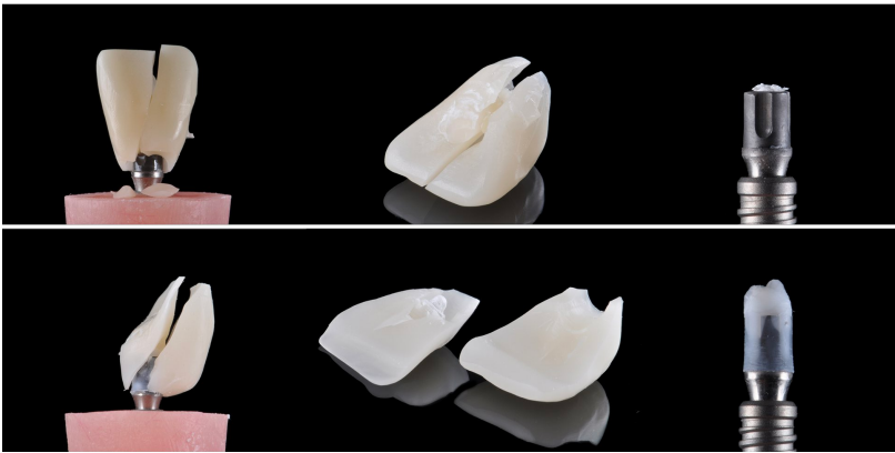
Figura 14: Emax PACP com fratura bucolingual típica e superfície de base de titânio limpa (superior). Shofu PACP com fratura mesiodistal típica e cimento resinoso remanescente nas bases de titânio (parte inferior). Fonte: Autor.
