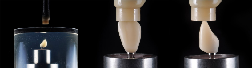
Figura 8: Sistema de teste com câmara de carga para teste submerso e visão detalhada da carga de amostra antes da imersão. Observe o contato de toda a borda incisal com o cilindro de resina composta plano que atua como pistão. Fonte: Autor.
