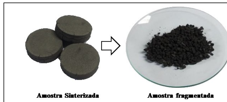
Figura 17: Imagem das amostras sinterizadas e fragmentadas
