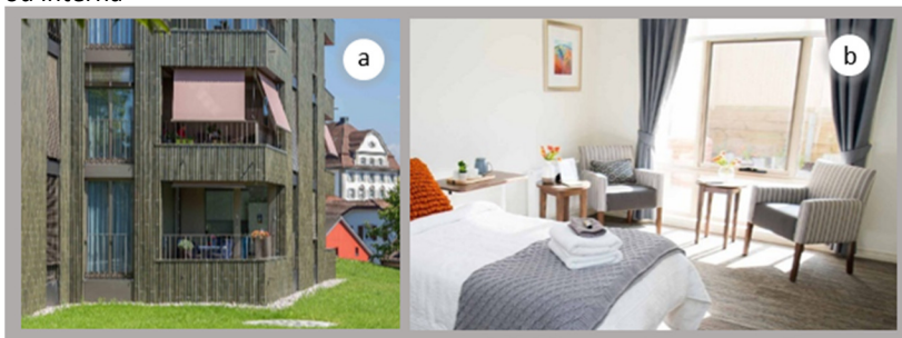
Figura 16: Controle de iluminação natural por meio de proteção solar externa ou interna
