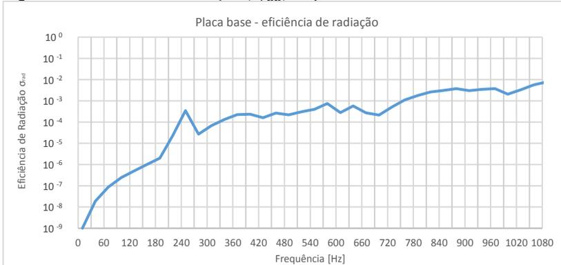
Nota-se que, na faixa de interesse (até 1 kHz), a eficiência de radiação da placa base pode ser considerada baixa. Isso possivelmente decorre da forma da placa e da presença de recortes e furos na mesma, o que tende a reduzir a eficiência de radiação do corpo.
