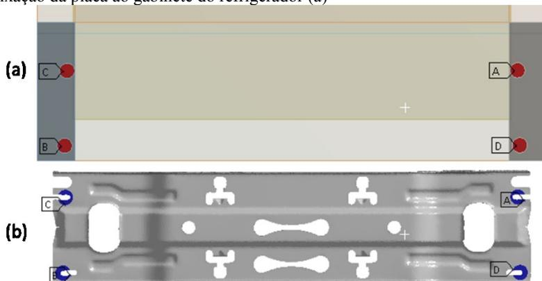
Figura 74 - Elementos de contato criados na junção entre a placa base e o gabinete.
