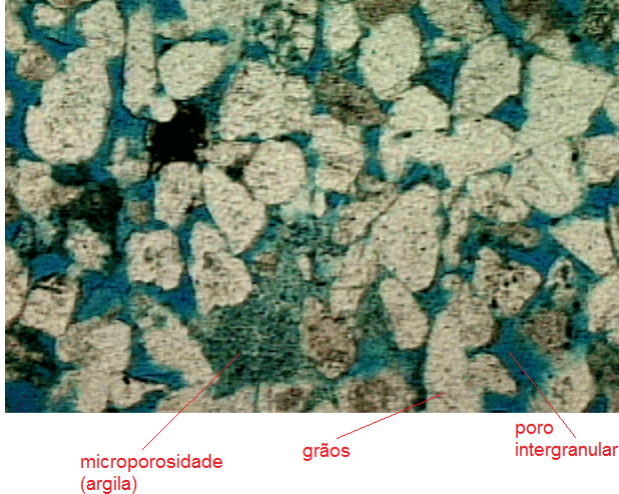
Figura 1 – Imagem 2D de um arenito Berea obtida com microscopia óptica em lâmina delgada
