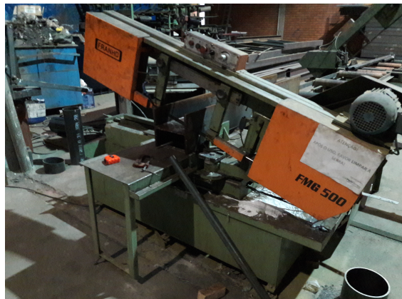
Figura 39 – Fabricação - Corte da Viga W
