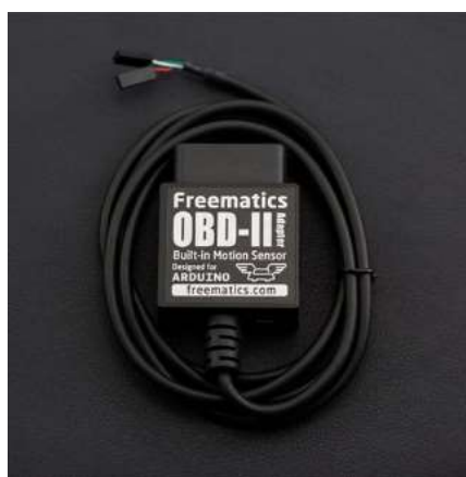
Figura 3 - Interface de comunicação CAN-Arduino Freematics OBD-II UART Adapter.
