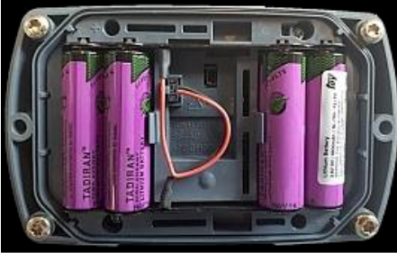
Figura 38 - Conjunto aberto e bateria
