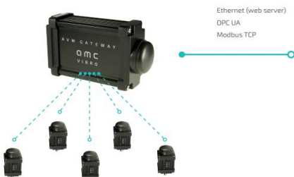
Figura 44 - Comunicação do gateway AMC
