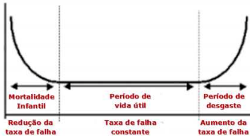
Figura 1 - Curva de banheira: probabilidade de falha
