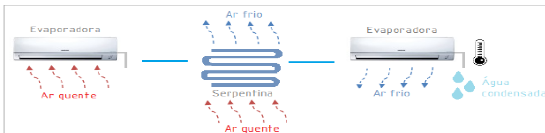
Figura 3: Etapa simplificada da produção de água condensada. Fonte: ROCHA (2017).
