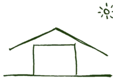
Figura 4: Croqui demonstrativo de uma edifica\u00e7\u00e3o com beirais prolongados (Elaborado pelos autores, 2019)
