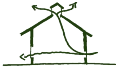
Figura 8: Croqui demonstrando a ventilação cruzada no ambiente (Elaborado pelos autores, 2019)
