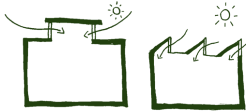
Figura 6: Croqui demonstrativo de iluminação zenital nos modelos lanternim e shed (Elaborado pelos autores, 2019)
