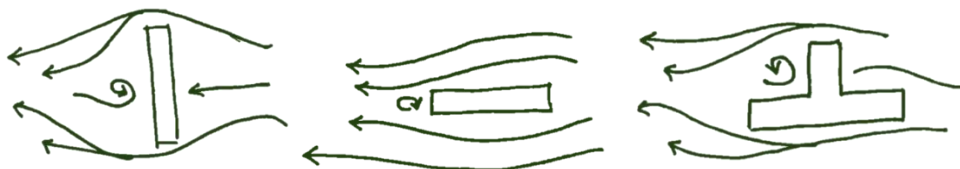
Figura 7: Croqui demonstrando a circulação da ventilação em diferentes formas construtivas (Elaborado pelos autores, 2019)
