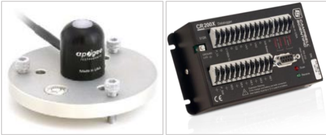
Figura 19: Piranômetro (esquerda) e datalogger (direita) usados para obtenção da radiação
