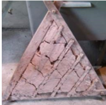
d) Trama com espaçadores entre as tiras de bambu e painel após ensaios, LILD, PUC/Rio de Janeiro
