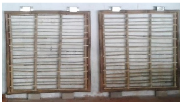
Figura 44 - Montagem dos dois painéis de vedação.
