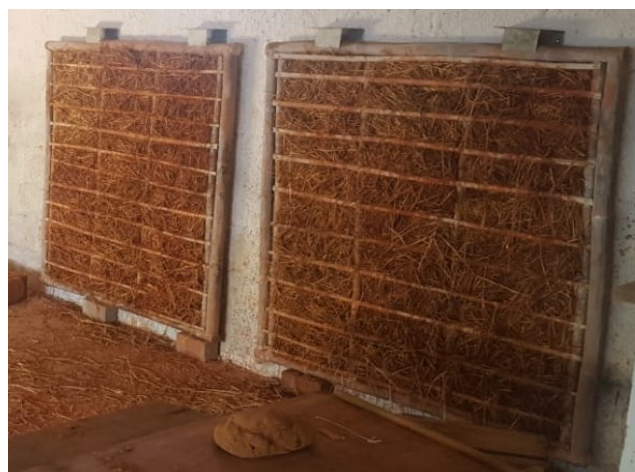
b) Preenchimento com fibra
