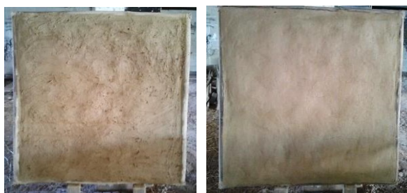
c) Painel A, aplicação do emboço e do reboco em uma das faces
