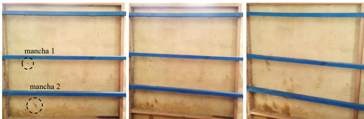
Figura 47 - Evolução das primeiras manchas de umidade durante o ensaio no CP-A, na primeira hora, e após 2 e 6 horas.
