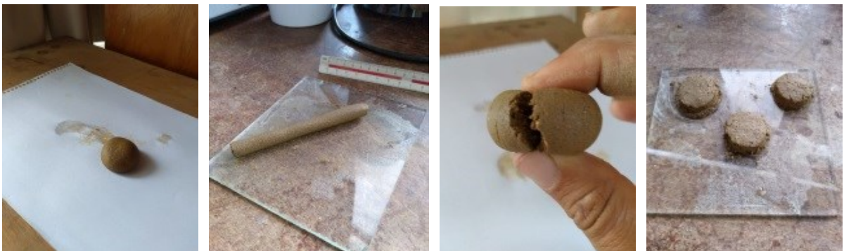
Figura 37 - Testes de campo do solo a ser utilizado nas argamassas de terra do objeto de estudo: queda de bola, cordão, fita e resistência seca.
