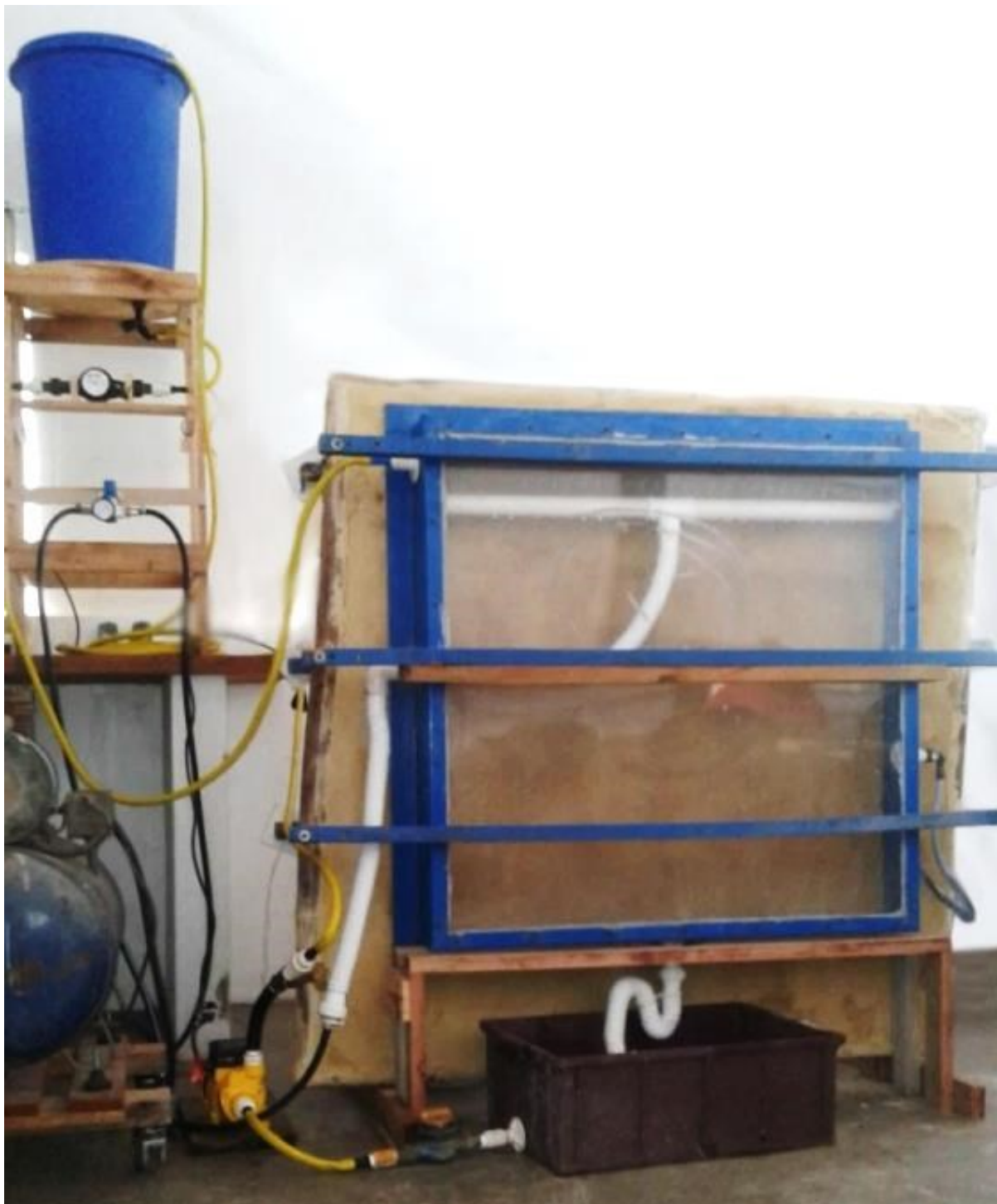
Figura 34 - Equipamento para o ensaio de estanqueidade montado no Labrestauro/MATEC/UFSC.
