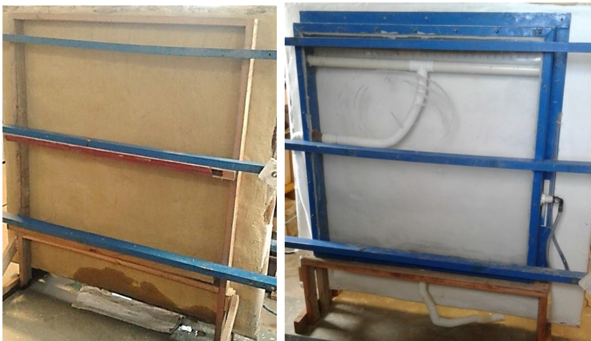
Figura 50 - Face interna e externa CP-B após o ensaio de estanqueidade, com a delimitação da área da câmara.
