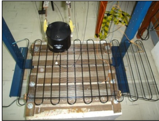
Figura 4.22– Ensaio do condensador na condição rigidamente engastada.
