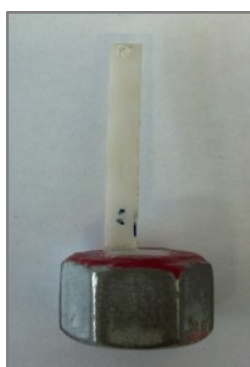
Figura 4.30– Amostra da conexão utilizada, em formato de viga, na determinação das propriedades do material.
