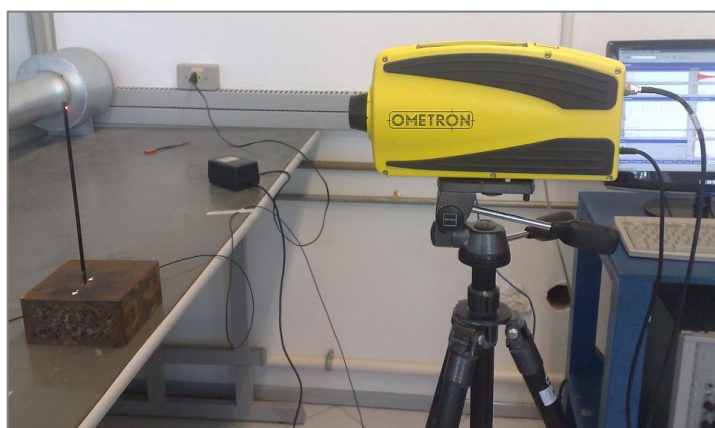
Figura 4.4— Ensaio para a determinação do módulo de elasticidade do tubo do condensador.
