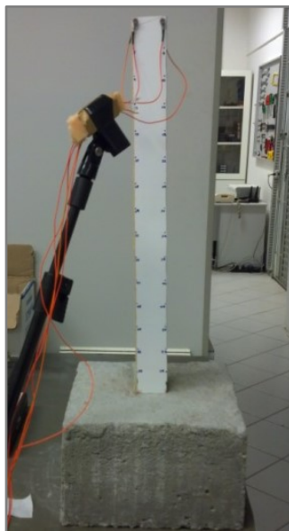
Figura 6.3– Análise modal experimental da viga sanduíche. Pontos de medição sobre a chapa de aço.
