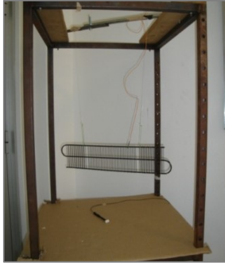
Figura 4.11– Ensaio de análise modal da seção do condensador utilizando martelo de impactação e acelerômetro.
