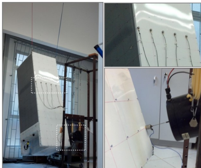
Figura 6.13– Análise modal experimental do gabinete. Na esquerda a configuração geral. Na direita superior acelerômetros utilizados. Na direita inferior o excitador electrodinâmico.
