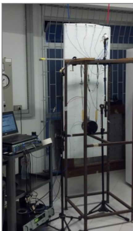
Figura 6.18– Configuração geral do teste de análise modal realizada na porta.
