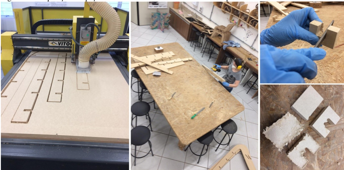
Figura 44 - Preparação das peças da estrutura: corte na CNC e lixamento pós corte.
