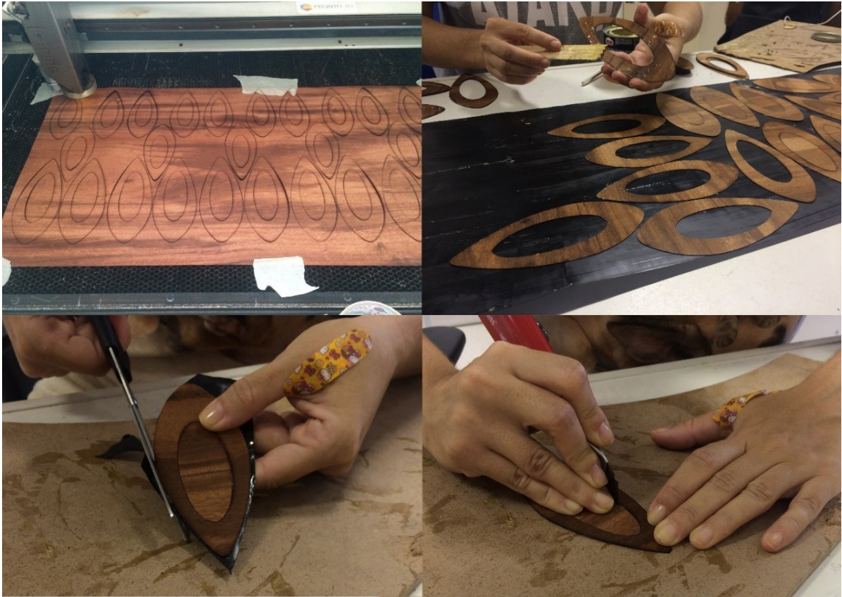
Figura 47 - Produção dos componentes em série. Em sentido anti-horário, do topo-esq.: corte a laser, colagem no alumínio, recorte do alumínio.
