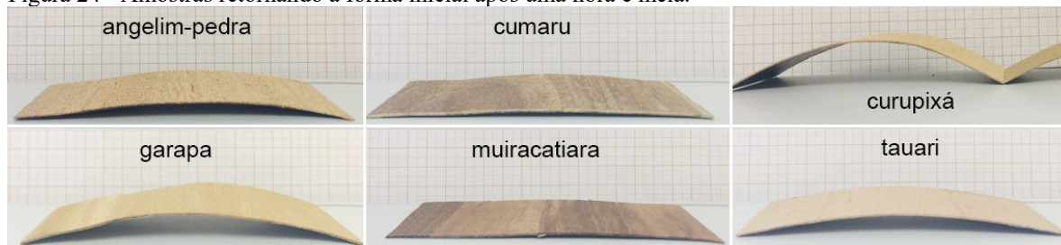
Figura 24 - Amostras retornando à forma inicial após uma hora e meia.
