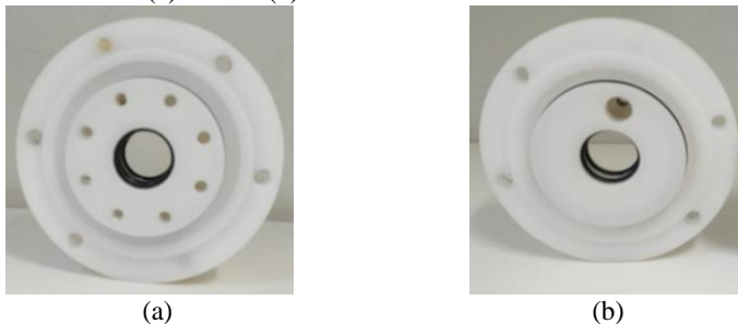
Figura 12 – Entrada (a) e saída (b) do reator tubular construídas com teflon.
