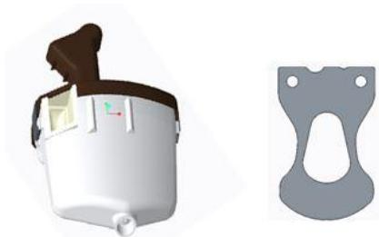
(a) Muffler de Sucção (b) Válvula
