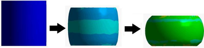
Figura 6.20: Caso 3 para verificação de volume - coeficiente de poisson igual a 0,4999, atrito igual a 2,5, deslocamento de 2,45 mm.
