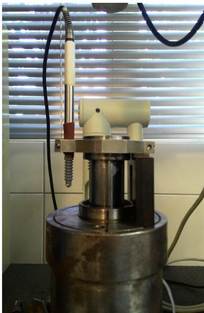
Figura 6.9: Montagem do LVDT no dispositivo de ensaio.
