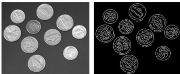
Figura 6.12: Exemplo de utilização das ferramentas de detecção de perfis do matlab. Imagem adaptada da documentação do Matlab 2013a.
