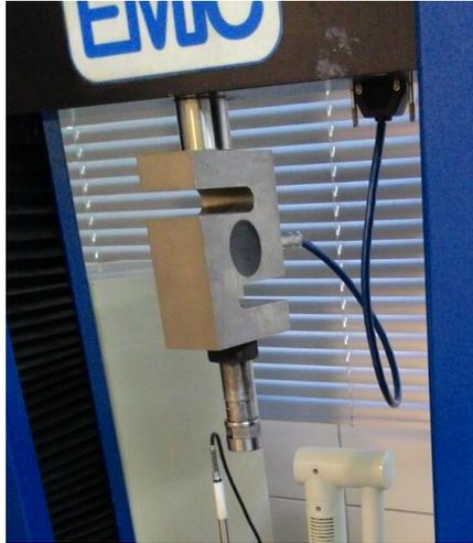
Figura 6.8: Célula de carga utilizada para efetuar a medição de força durante os ensaios de compressão.
