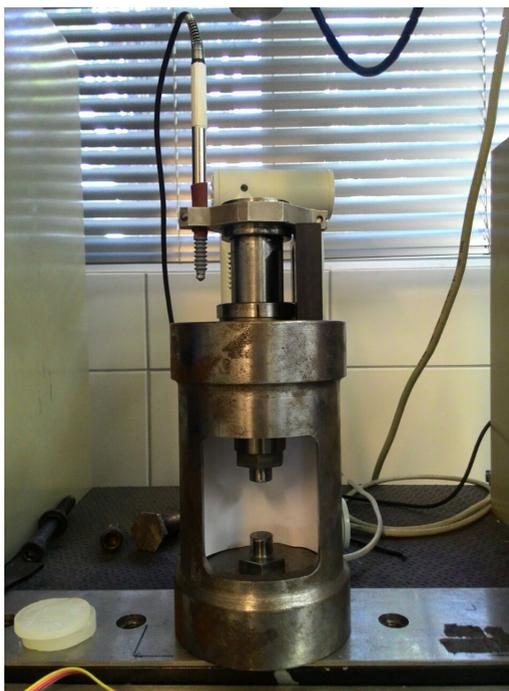
Figura 6.2: Dispositivo de ensaio de compressão uniaxial utilizado. Fotografia realizada pelo autor.
