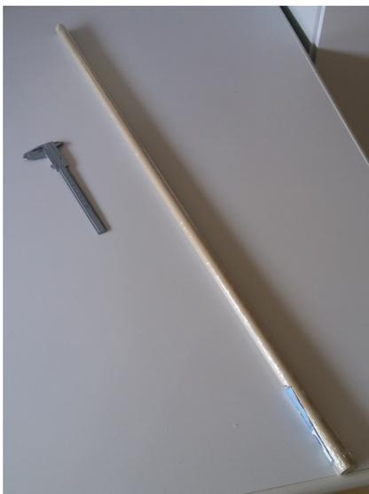
Figura 6.1: Um dos tarugos de PEEK disponibilizados para testes nesse trabalho (ao lado, um paquímetro de 20cm para compreensão da escala da imagem). Fonte: fotografia realizada pelo autor. .
