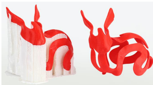
Figura 15 - Exemplo de uma peça impressa com material de suporte (branco) e depois deste material ser removido (apenas vermelho).
