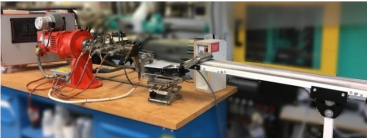
Figura 18 – Extrusora monorosca Friul Filiere SpA, modelo Estru 13.
