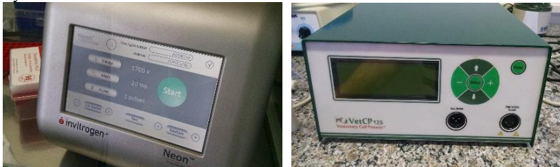
Figura 22 – Eletroporadores observados. À esquerda Neon® Transfection System. À direita VetCP 125®.
