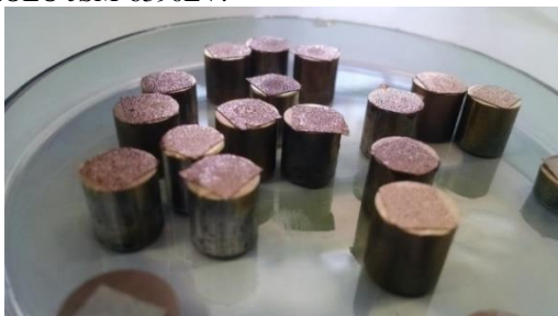
Figura 36 – Amostras recobertas em ouro em stubs . Preparação necessária para análise com JEOL® JSM-6390LV.
