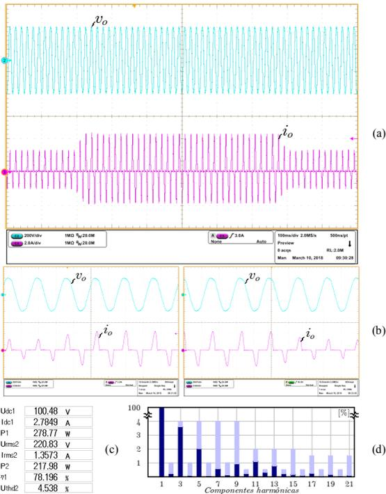
Figura 4.32 - Resultados experimentais - SCDBI - Carga não-linear, operando em malha fechada (3NL) sob degrau de carga: (a) tensão de saída  $v_o$  (200 V/div), corrente de carga  $i_o$  (2 A/div) e base de tempo (100 ms/div); (b) detalhe (10 ms/div) durante degrau de carga ( $\pm 5\%$ ); (c) analisador de energia: entrada/saída; (d) conteúdo harmônico da tensão de saída.
