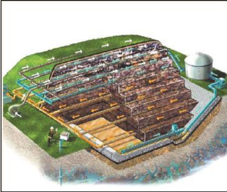
Figura 27 - Representação de um aterro sanitário.
