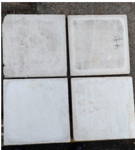
Figura 21 – Placas de argamassa geopolimérica (300x300x40)mm.
