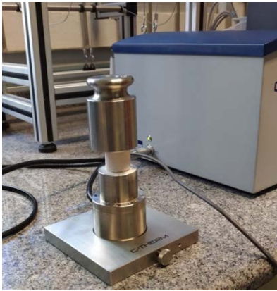
Figura 19 – Medição da condutividade térmica com aparelho C-Therm
