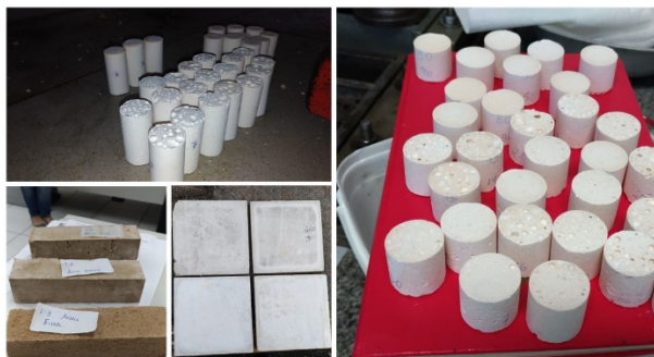
Figura 18 – Moldagem das amostras
