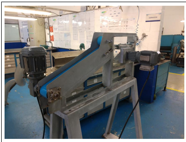
Figura 6.3 – Protótipo evidenciando orientador de cabeças e primeiro transportador enfileirador
