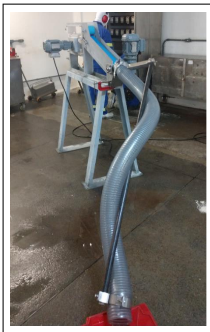
Figura 6.2 – Aspecto final do protótipo do alimentador automático
