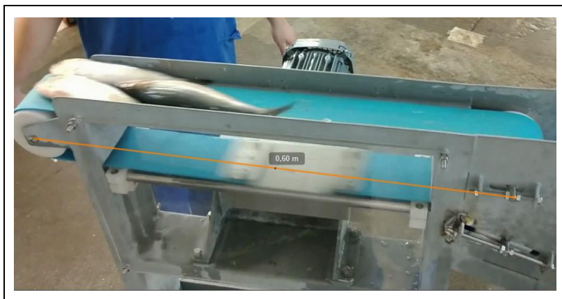
Figura 6.7 – Calibração de dimensão física do orientador de cabeças no Software Kinovea
