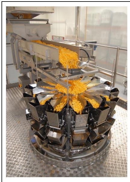
Figura 2.10 – Alimentador multicabeçote Fonte: Ishida Corporation Ltd., 2017
