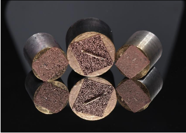
Figura 1 – Preparo prévio à análise em MEV dos stubs contendo o material a ser analisado, após o recobrimento com pó de ouro.
