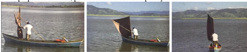
Figura 27 - Bateira com vela de espicha. Nota-se que a vela está sendo utilizada como propulsão auxiliar, pois é visível a caixa de proteção do motor.
