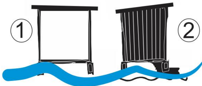
Figura 43 - Croqui de sarilho simples com cobertura uma água.
