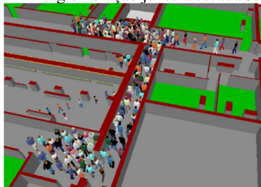
Figura 82 - Simulação da evacuação do Colégio Catarinense no cenário 1 – gargalos e aglomeração junto a escada 3.
