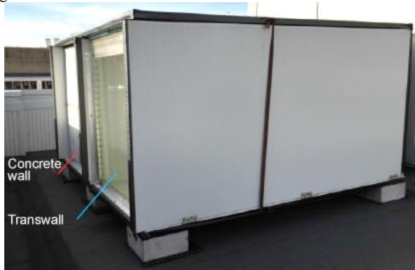
Figura 8: Modelo em escala real de transwall e waterwall de concreto.
