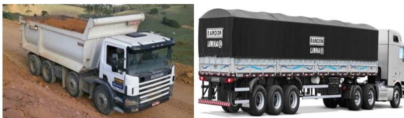
Figura 62 - À esquerda imagem do caminhão caçamba. À direita imagem do caminhão graneleiro
