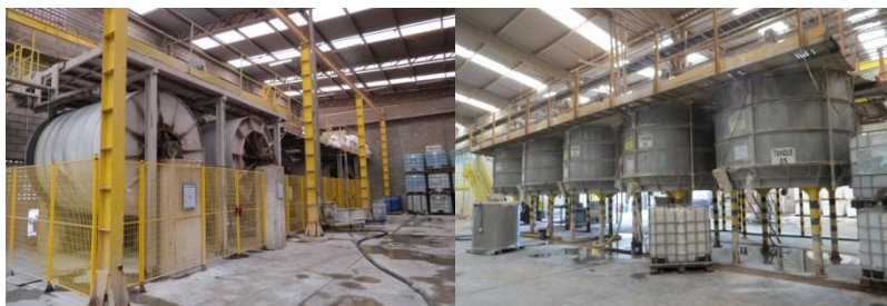
Figura 28 - Fotos do setor de esmaltação da Angelgres. À esquerda, moinhos para preparação dos esmaltes. À direita, tanques de armazenamento dos esmaltes
