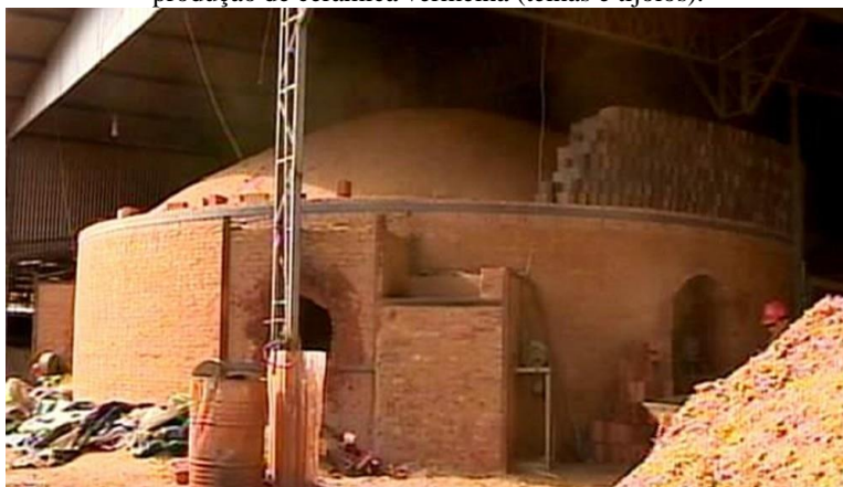
Figura 7 - Forno intermitente “tipo garrafão” atualmente utilizado somente na produção de cerâmica vermelha (telhas e tijolos).
