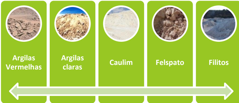
Figura 13 - Principais matérias-primas utilizadas na composição da massa cerâmica
