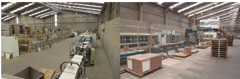
Figura 29 - Setor de escolha e embalagem da Angelgres. À esquerda, setor de máquina de escolha automática e, à direita, máquina de paletização, ambas produzidas pela System
