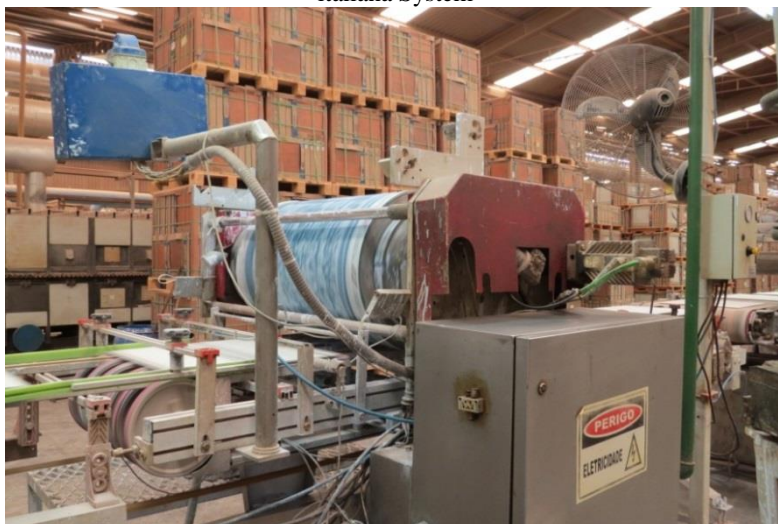
Figura 25 - Foto da serigráfica rotativa Rotocolor produzida pela empresa italiana System
