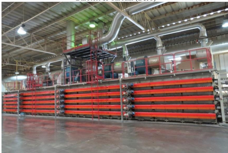
Figura 23 - Foto de um secador horizontal produzido pela empresa italiana Barbieri & Tarozzi (B&T)
