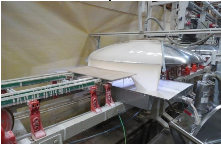
Figura 24 - Foto de parte da linha esmaltação - aplicação da primeira camada de engobe
