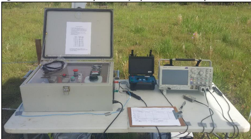
Figura 20 – Bancada do “setup” de medição para resistência e impedância.
