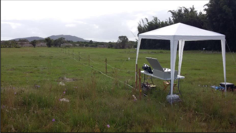
Figura 21 – Condutores da bancada de medição até os eletrodos auxiliares.
