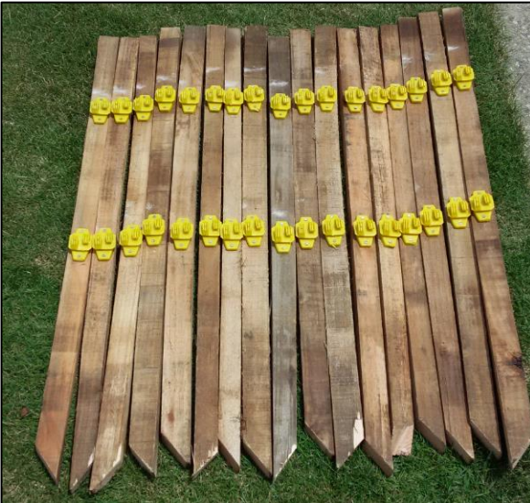
Figura 22 – Estacas para suporte dos condutores dos eletrodos auxiliares.
