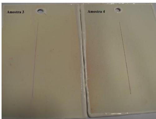
Figura 27 - Análise de salt spray para amostra 3 e 4 em ferro.
