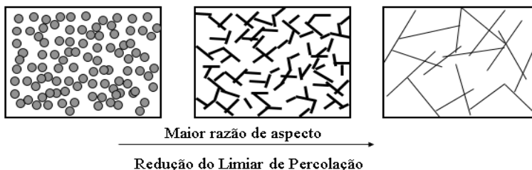
Figura 2 - Esquema ilustrativo do efeito da razão de aspecto na formação dos caminhos condutores e redução do limiar de percolação.
