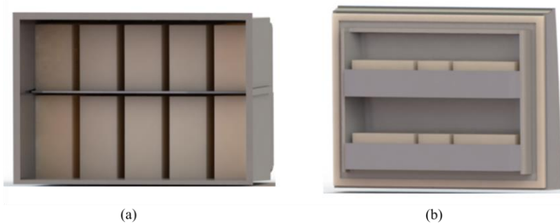
Figura 6.1 – Distribuição dos pacotes de tylose : (a) prateleira do compartimento freezer e (b) prateleiras da porta do compartimento freezer
