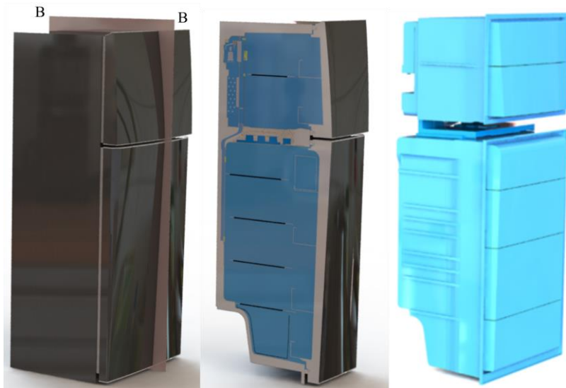
Figura 4.13 – Geração do domínio fluido no interior do refrigerador
