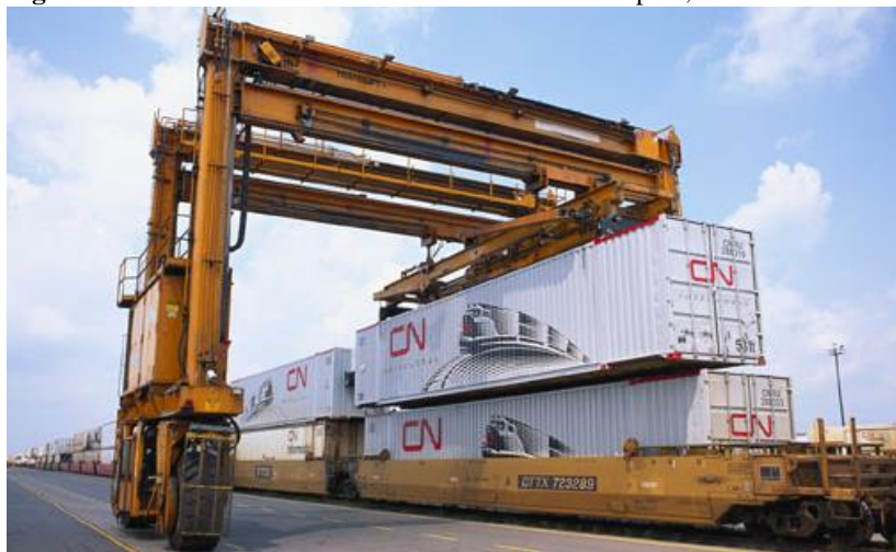
Figura 12 - Transtainer colocando containeres em Brampton, Ontario/Canada
