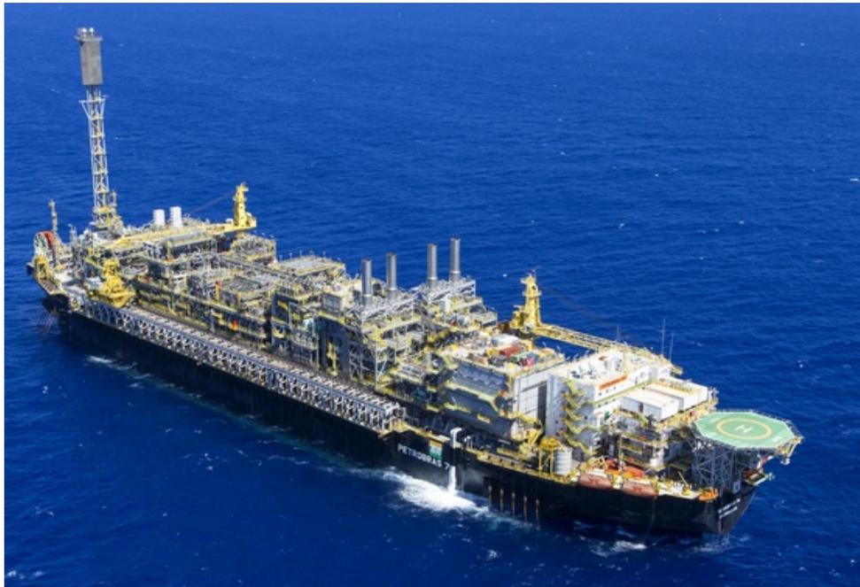
Figura 17 – FPSO (do inglês, *Floating Production Storage and Offloading*) utilizada na indústria de petróleo e gás
