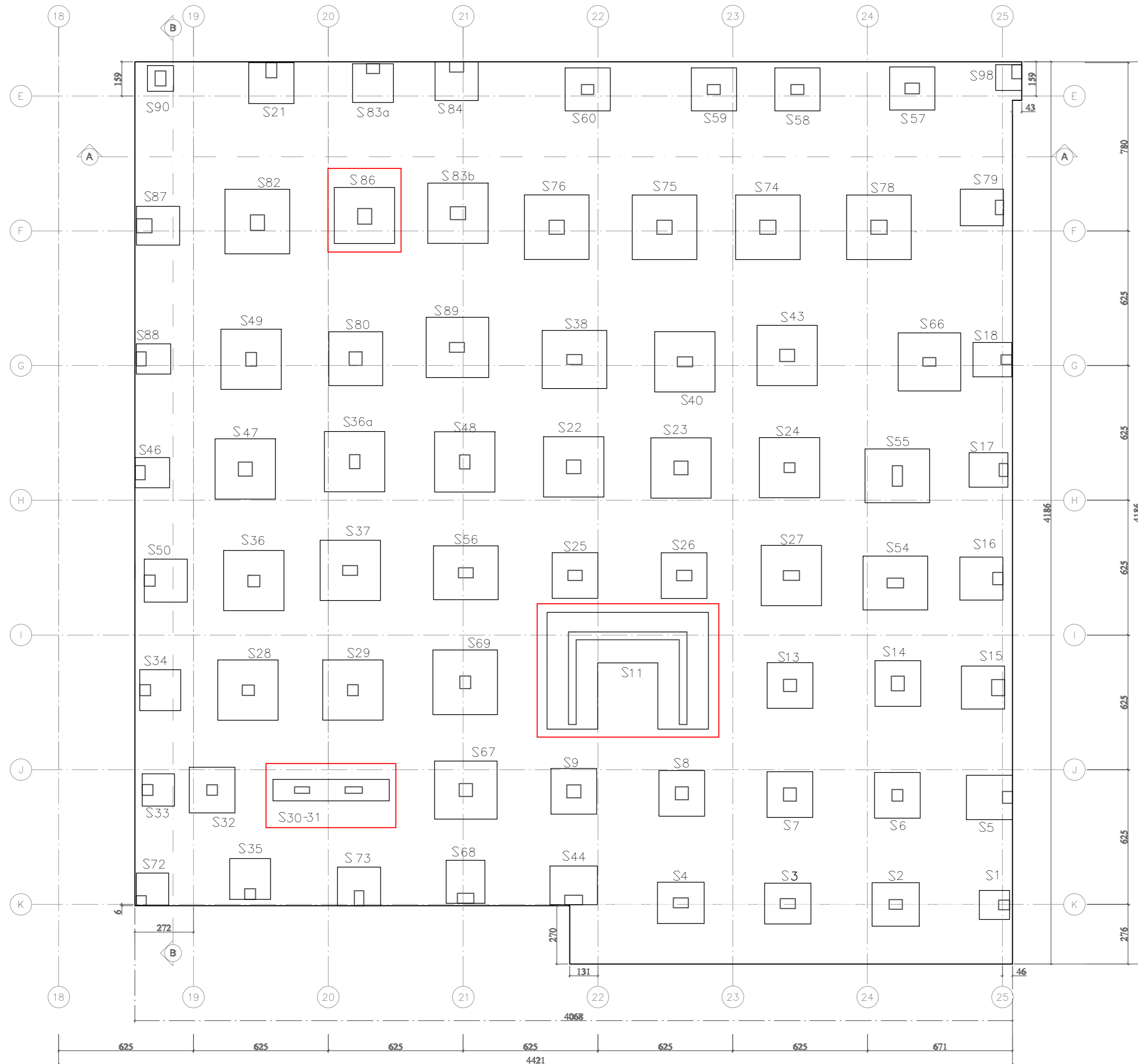
2) Locação das sapatas Sem Escala
