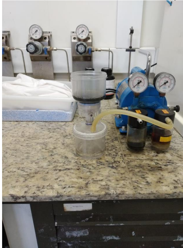
Figura 1 – Filtração com membrana de acetado de celulose com porosidade de 0,45\mu\text{m} .
