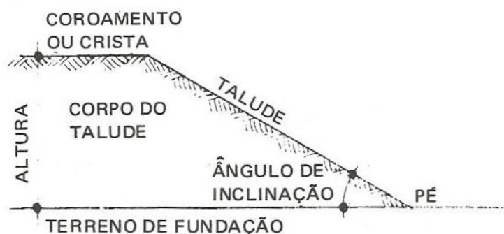
Figura 1: Exemplo da geometria de um talude com seus elementos.
